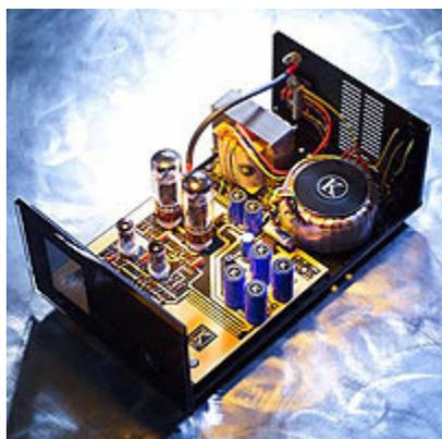
Nonostante una potenza dichiarata di "soli" 40 watt in classe A, i Kent Gold improved, come i Tine mono, sono in grado di pilotare anche diffusori estremamente critici, grazie ad una alimentazione ben progettata e ad i suoi straordinari trasformatori d'uscita molto sovradimensionati.
